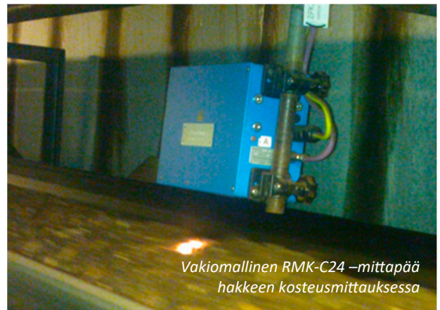
Lähetin MV-230 T ja mittapää RMK-C24 pölysuojineen suotonauhapuristimella
