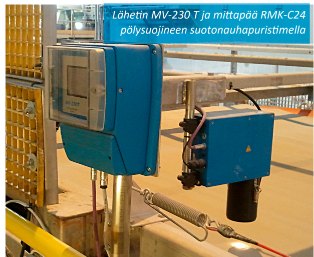
Vakiomallinen RMK-C24 -mittapää hakkeen kosteusmittauksessa
